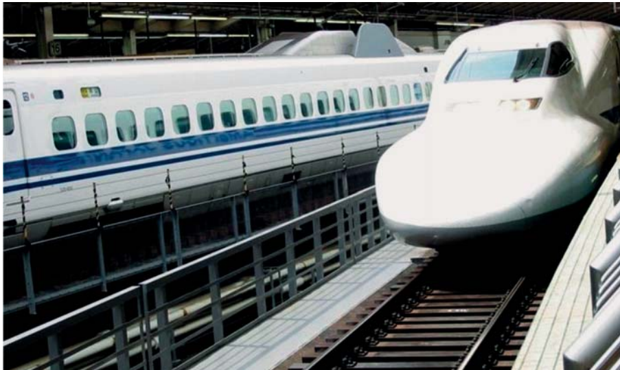
Abb. 1: FFU Kunstholz im Stationsbereich Tokyo Station
